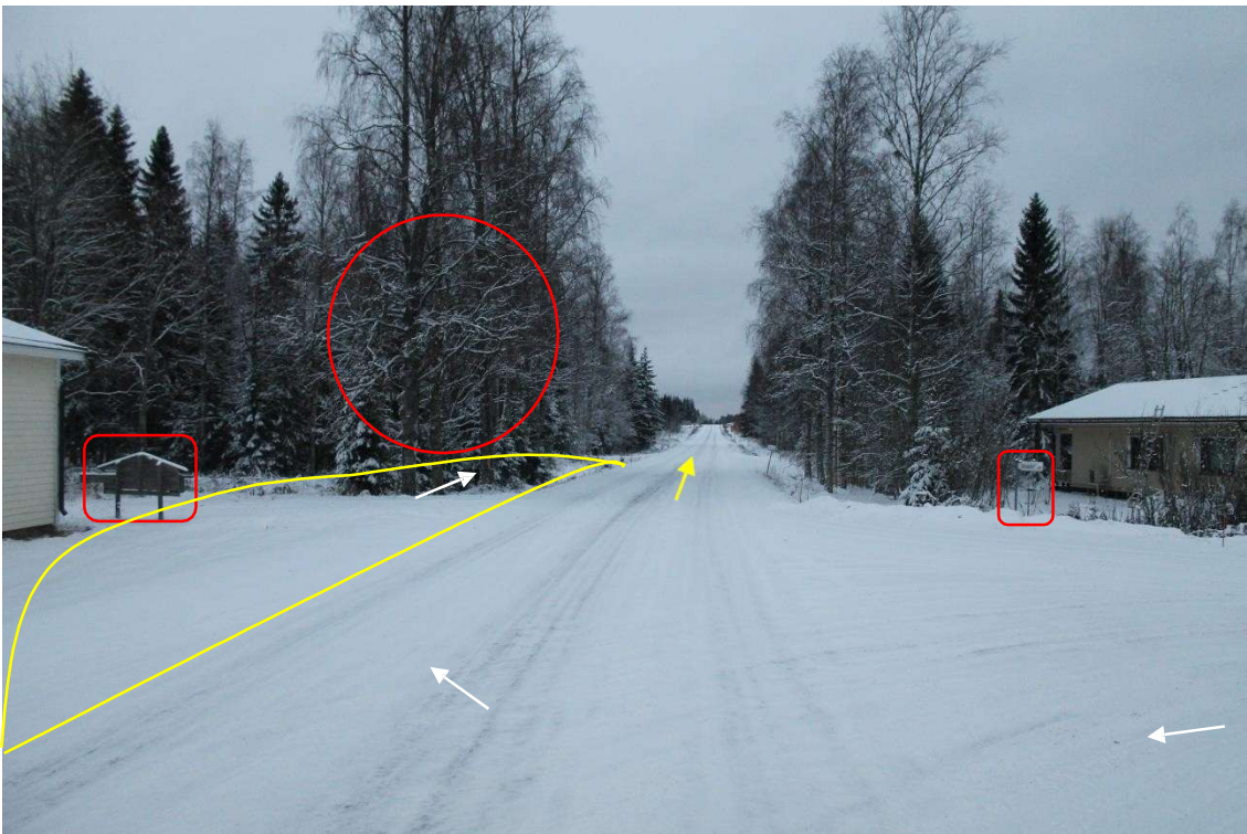
Pos 31/Kuva 88. Käänny tieltä 7693 tielle 560. https://maps.app.goo.gl/UmHYgTTsCNYTFJB77 Toinen vaihtoehto: Lisätutkimuksia tarvitaan, koska yksityisalueella on tehtävä tien muutostöitä. Tee lisää tilaa tien vasemmalle puolelle, tyhjälle tontille. Merkityt puut on kaadettava. Merkitty alue on täytettävä ja tehtävä ajokelpoiseksi. Merkitty postilaatikko ja kyltti on poistettava. Valkoinen nuoli osoittaa tornien ajosuunnan. Loput reitti on sama kuin reitillä 1.
